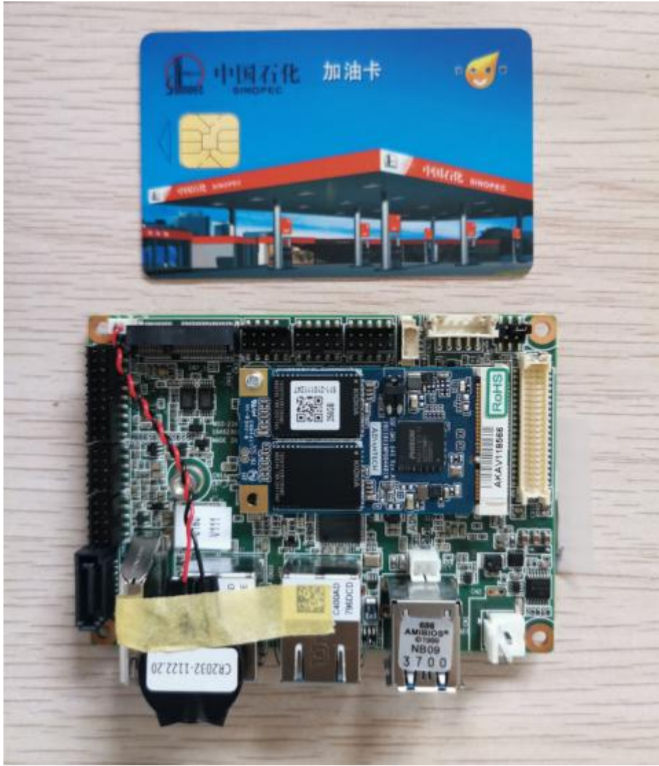
图 6：研华高性能 COME（SOM）模块化控制器（X86 CPU）
